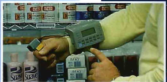
Captación y transmisión de datos vía radio
