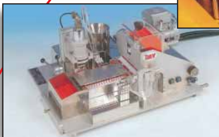
Máquina llenadora de pajuelas de 0,5 ml "12.960 pajuelas a la hora"
