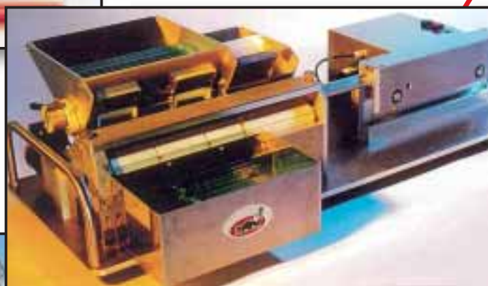
Máquina posicionadora de pajuelas en cánulas rectas
