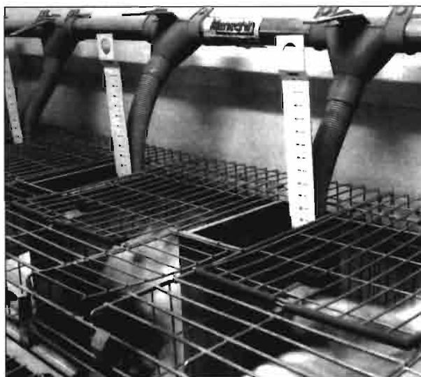
Distribución en tolva por tubo flexible (detalle).
