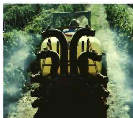
Alternativas para adaptar la salida de aire a las características del cultivo.
