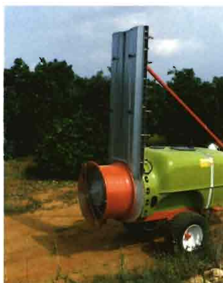
Alternativas para adaptar la salida de aire a las características del cultivo.
