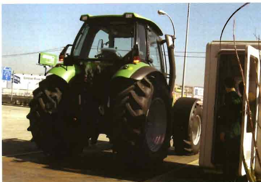
Antes de realizar los ensayos se procedió al pesado de los tractores.
