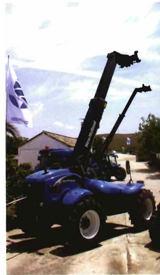
Una cargadora telescópica incorpora enganche de tres puntos y toma de fuerza.
