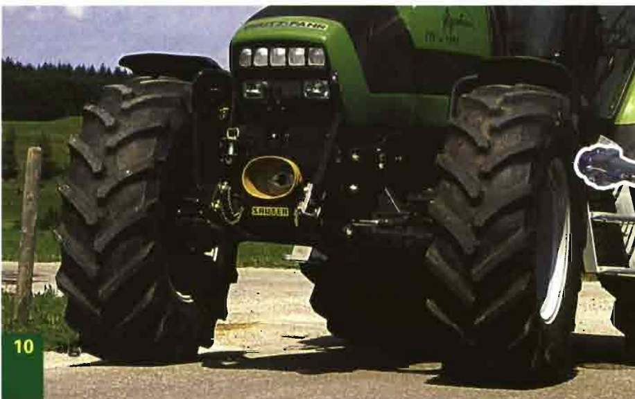
Detalle de eje delantero con el enganche y la toma de fuerza frontales.
