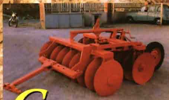
G RADA DE DESMONTE
