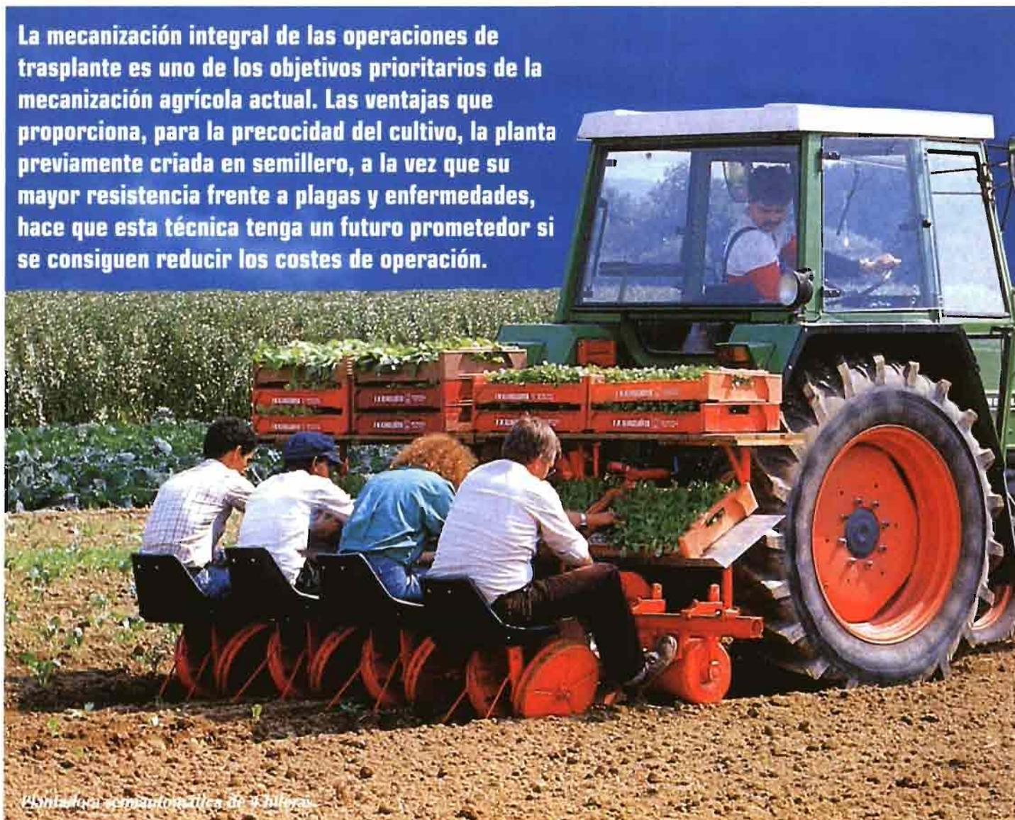
La mecanización del trasplante incluye no sólo a las máquinas conocidas como trasplantadoras, sino también al conjunto de equipos que sirven para preparar las plantas en el semillero (preparación del sustrato y siembra) y para el manejo mecanizado hasta que la planta llega a la máquina trasplantadora.
