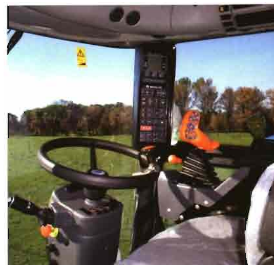
El monitor de control instalado en la cabina permite comprobar en todo momento las prestaciones de la vendimiadora.
