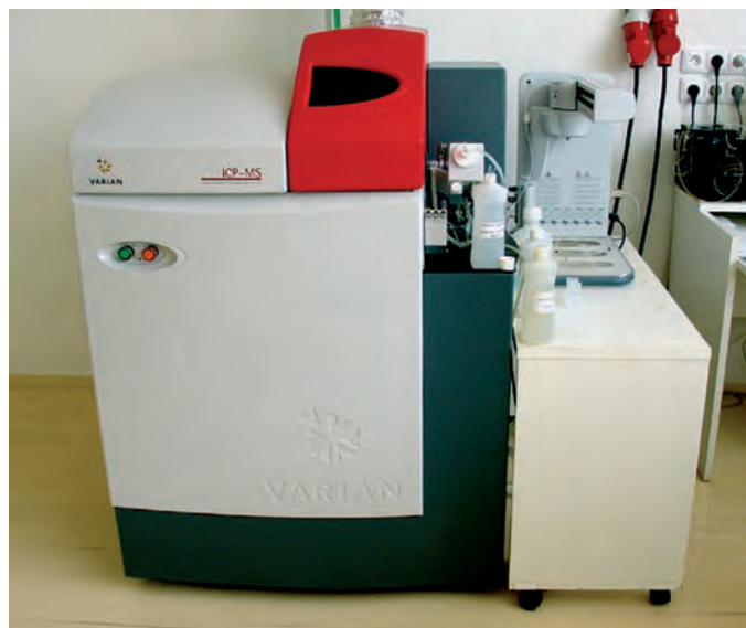
Foto 2. Unidad de espectroscopia ICP-MS utilizada para el análisis total de los elementos presentes en el suelo
