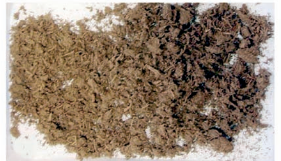
Fotografía 2. Poda de olivo tras pretratamiento por explosión con vapor
