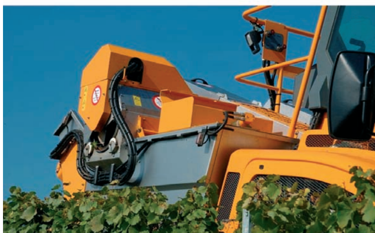
G152 con cuatro aspiradores (arriba) y vibrodespalilladora (abajo)
