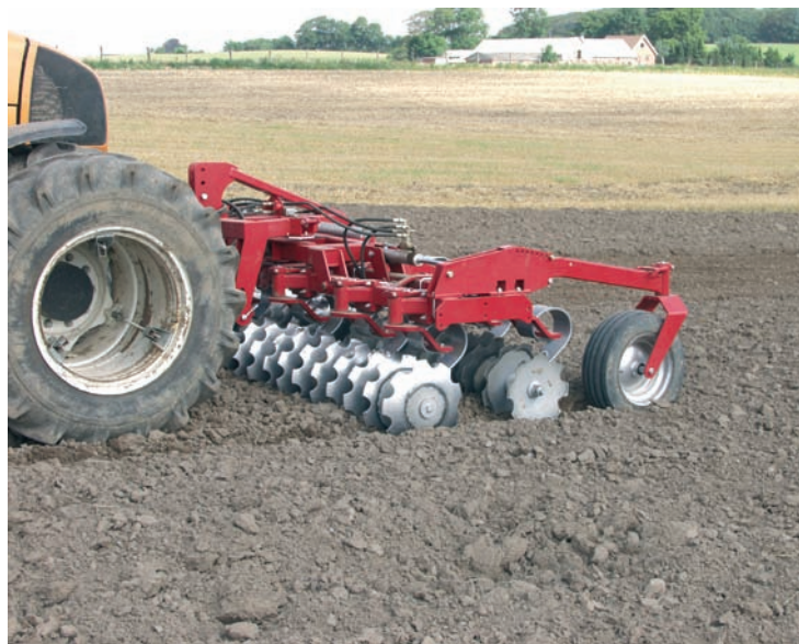
Secciones individuales montadas sobre brazos-ballesta
