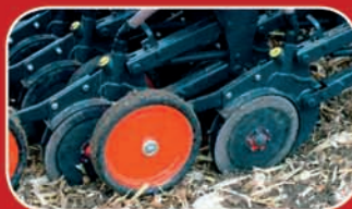
Discos sembradores sobre paralelogramo: siembra de profundidad homogénea.
