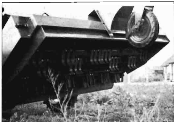
Vista del rotor de mayales y del rotor de latiguillos de una máquina deshojadora-descoronadora de 6 líneas.
