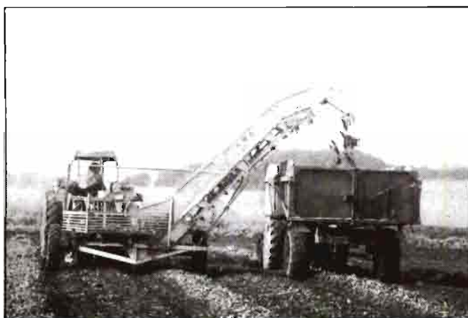
Recogedora-cargadora que cuenta con turbina limpiadora y transportador de barras.
