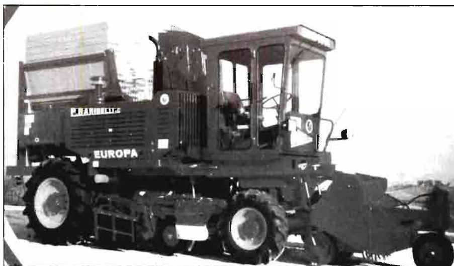
Cosechadora integral de gran capacidad de trabajo. (Velocidad de trabajo 8-10 Km/hora).
