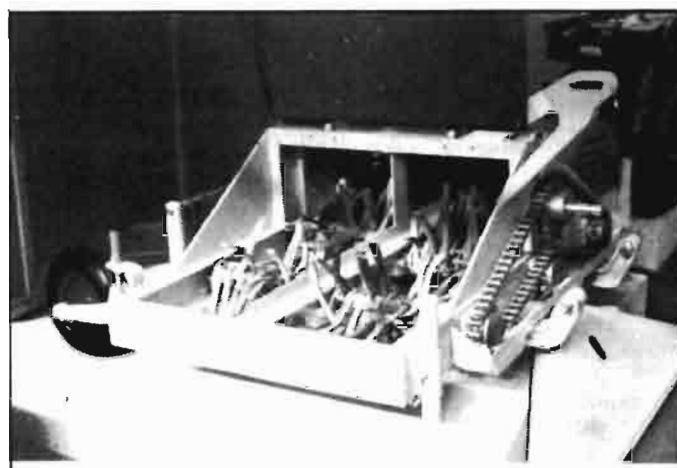
Máquina deshojadora-descoronadora de ejes longitudinales, provistos de latiguillos.
