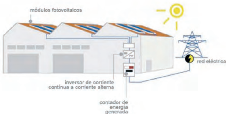
FIGURA 2 / Instalación fotovoltaica en cubierta "CONECTADA A RED"
