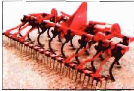
Figura 21.- Cultivador semisuspendido al tractor
