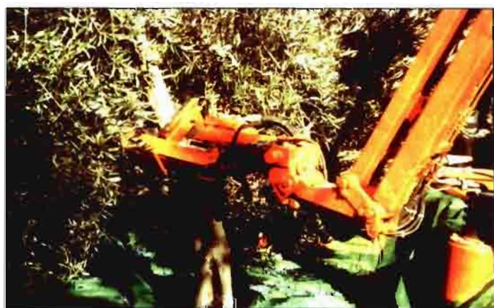
Mordaza de un vibrador al tronco de un olivo para el derribo mecánico de las aceitunas
