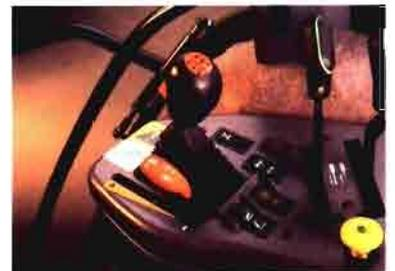
*Una sola leva realiza todas las funciones del cambio. Accionandola hacia adelante ponemos el tractor en marcha, las velocidades se introducen con suaves y rapidos desplazamientos laterales, accionando la leva hacia atras, se invierte el sentido de marchas. El primer cambio del mercado con automatismos para el transporte y para los giros en las cabeceras de las parcelas*
