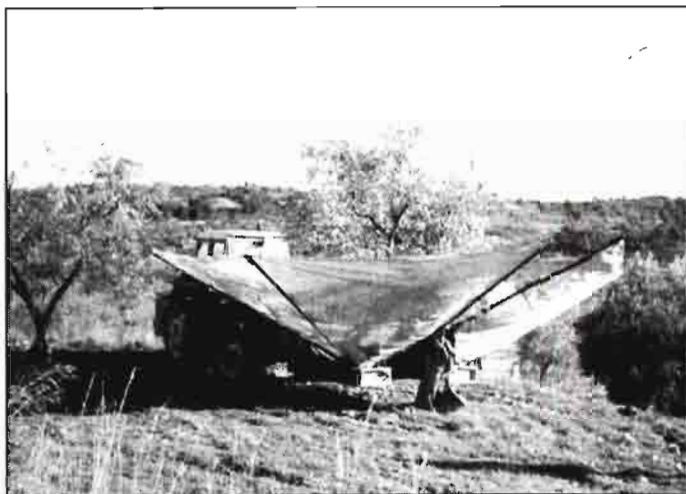
Recogida mecanizada utilizando un vibrador multidireccional de troncos con paraguas invertido.
