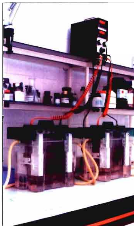
Cubeta utilizada para el estudio de la electroforesis en SDS-PAGE.
