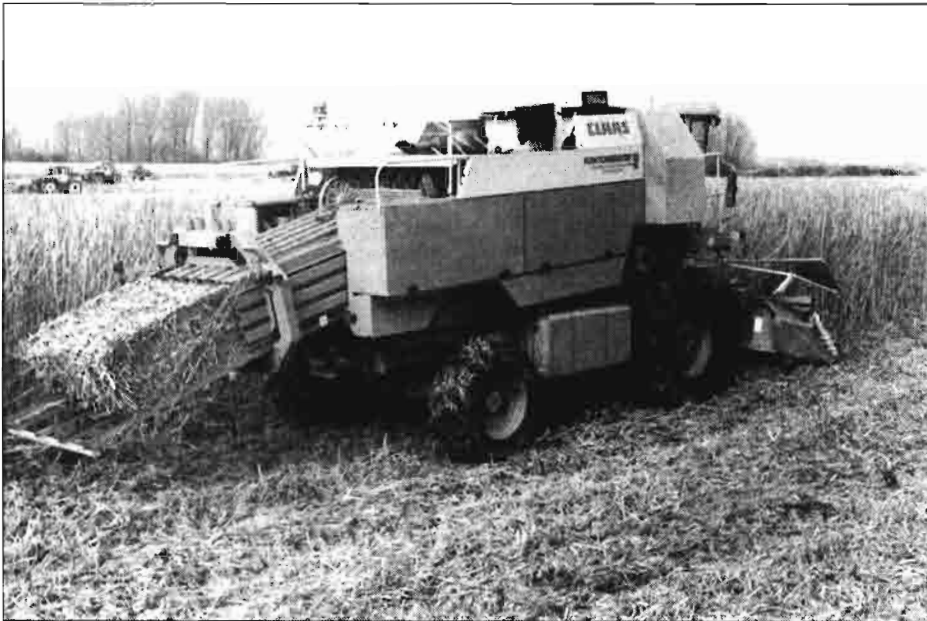
Cosechadora Prototipo de CLAAS, recolectando Miscanthus. Esta máquina combina las técnicas de picado y empacado.
