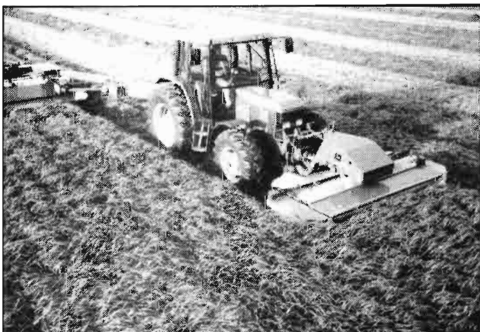
Tractor John Deere 6400 con motor de 4 cilindros y 100 CV de potencia nominal. La nueva generación de motores de los nuevos tractores dispone de potencia constante en una amplia gama de revoluciones y un muy bajo consumo de combustible. El sistema hidráulico es compatible con todo tipo de áperos hidráulicos.
