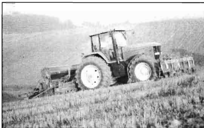
Tractor John Deere 7600 con motor de 6 cilindros y 130 CV de potencia nominal. Los motores de la serie forman parte del concepto modular del tractor y se disponen sobre el «bastidor único» con amortiguación de las vibraciones.
