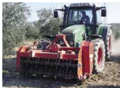
Figura 2. Tractor con tripuntal y t.d.f. delantera con una trituradora de ramón
