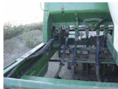
Figura 12. Sembradora directa de chorrillo mecánica con sistema de distribución variable mediante un motor hidráulico gobernado por controlador y GPS
