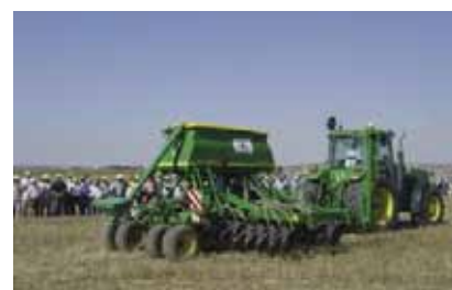
Figura 21. Sembradora directa neumática de disco de 6 metros de anchura.
