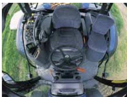
Figura 3. Mandos de un tractor con cabina ergonómica
