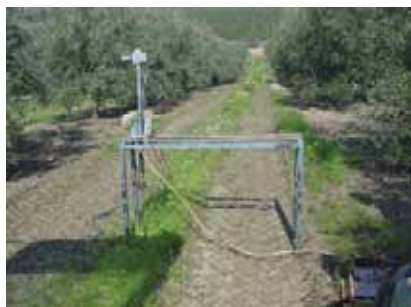
Figura 6. Daño a la cubierta por el paso de equipos de recolección. Medida de la compactación en la huella mediante penetrometro
