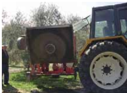
Figura 10. Desbrozadora de cuchillas de dos cuerpos plegada para el transporte
