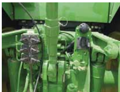
Figura 4. Tomas remotas y conexiones eléctrica y virtual (ISOBUS).
