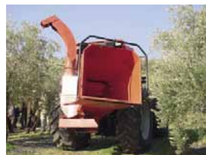
Figura 8. Trituradoras de alimentación manual mostrando el túnel de entrada de leña
