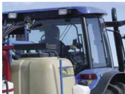
Figura 9. Tractor aplicando herbicida con un sistema de ayuda al guiado con indicación en una PDA.
