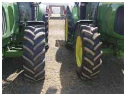
Figura 5. Neumáticos delanteros de baja presión (izquierda) y convencionales (derecha)
