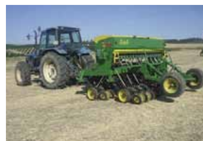
Figura 20. Sembradora directa mecánica de chorrillo con tractores de potencia media
