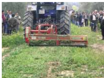
Figura 11. Desbrozadora de martillos de eje horizontal con cilindro de desplazamiento lateral.
