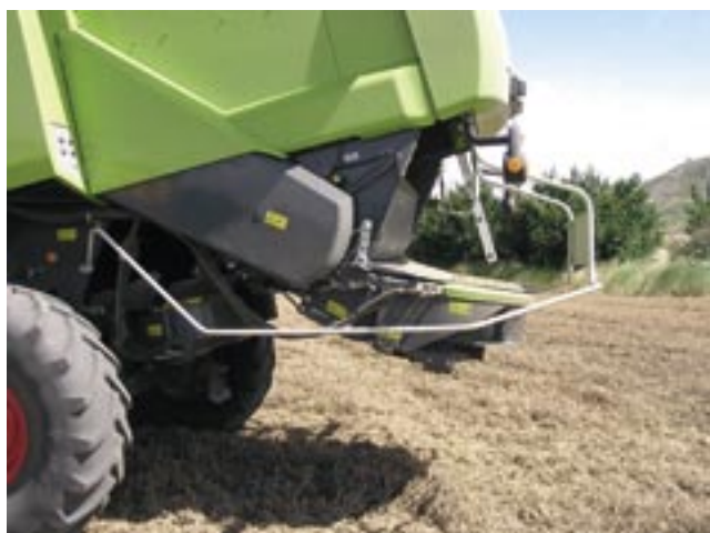
Detalle de esparcidor conjunto para paja picada, granza y tamo.
