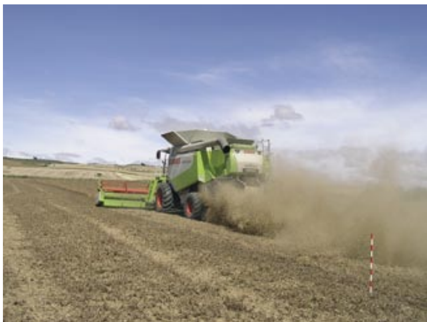
La distribución uniforme de paja, granza y tamo es fundamental para hacer siembra directa, en particular con máquinas de disco.
