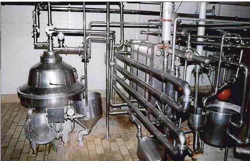
Fig. 18.–El desnatado y la posterior eliminación de las esporas de la nata antes de su reincorporación es un método alternativo a la bactofugación.
