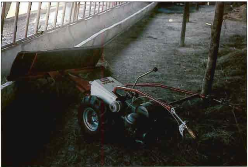
Fig. 13.-Para la recogida de las deyecciones, además de los suelos emparrillados, son muy útiles las arrobaderas tanto acopladas a una máquina autopropulsada como automáticas.
