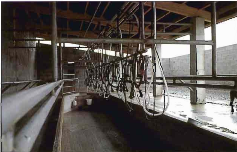
Fig. 11.–Una sala de ordeño sencilla pero bien diseñada y con una higiene adecuada permite un mayor control de la contaminación que en el caso del ordeño en plaza.
