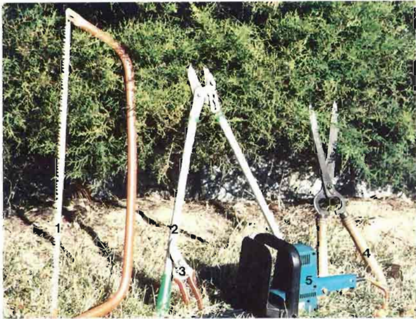
Fig. 19.—Herramientas de poda: 1. Sierra para troncos; 2. tijeras de uña para ramas leñosas gruesas; 3. tijeras de mano para limpieza; 4. Tijeras de perfilar y 5. cortasetos mecánico.
