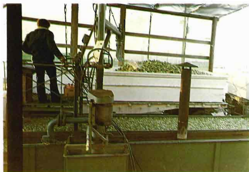
Fig. 32. —Llenado con agua de remolque y tratamiento fungicida simultáneo.
