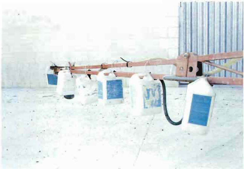
Fig. 5.—Control del caudal de las boquillas con recipientes.
