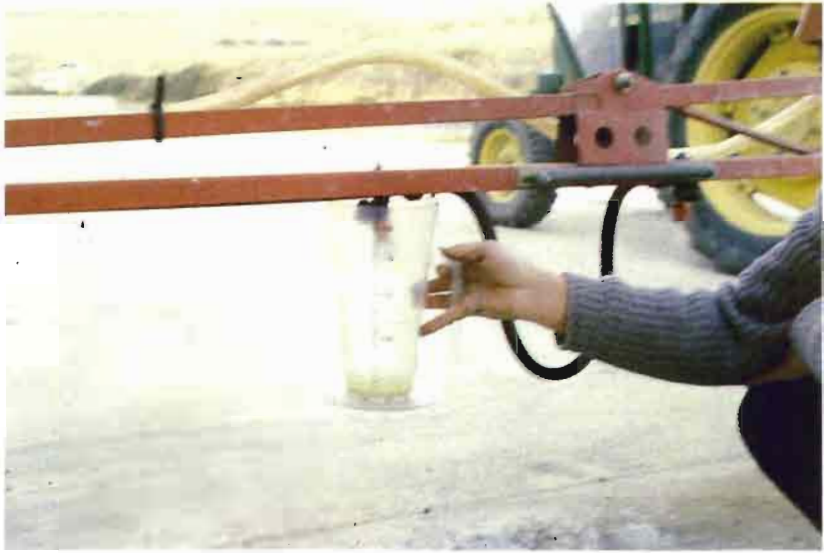
Fig. 4.—Control de caudal de las boquillas con una jarra graduada.
