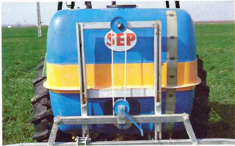
Fig. 10.—Mecanismo de sirga y manivela para regular la altura de la barra.
