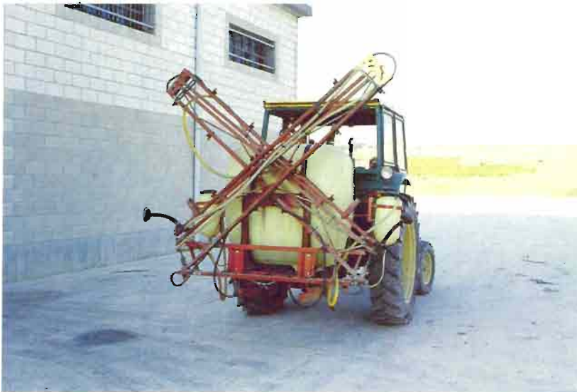
Fig. 1.—Pulverizador hidráulico en posición de transporte.
