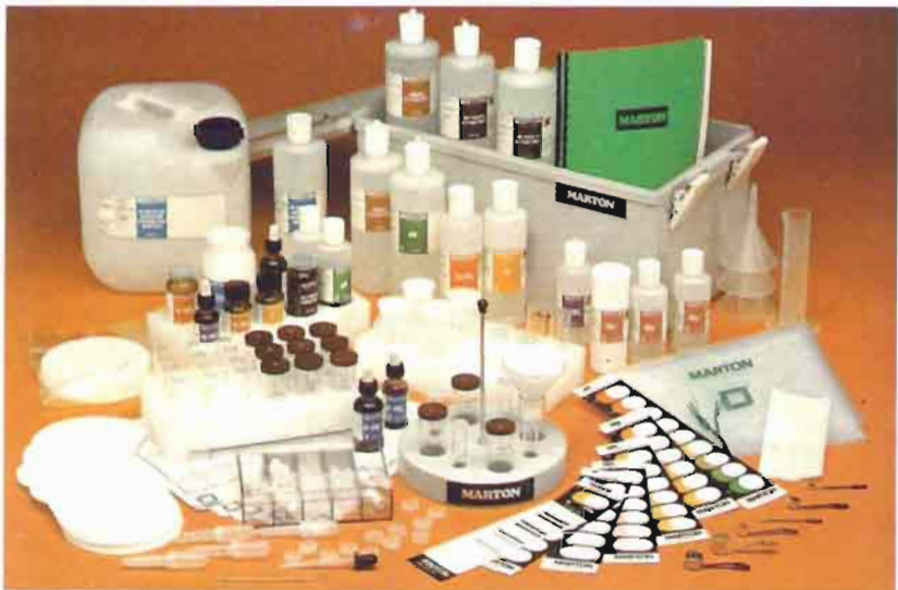
Fig. 3. — Equipo sencillo portátil para hacer 100 análisis de pH, 50 de nitrato, 50 de amonio, 50 de potasio, 50 de fósforo y 50 de magnesio. La determinación se realiza en cuestión de minutos por carta o tarjeta de colores. Elegido uno, se hace corresponder a un índice que nos señala en una tabla la cantidad de ese nutriente que hay en el suelo.
