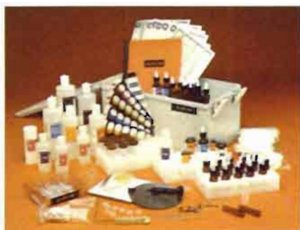
Fig. 17.—Equipo portátil para analizar savia y tejidos verdes con capacidad para llevar a cabo 800 tests: 50 para nitratos, amonio, fósforo, potasio y magnesio; 100 de boro, cobre, hierro, manganeso y cinc.
