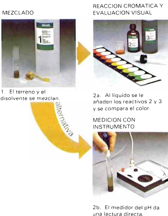
Fig. 4.—Para la determinación del pH de un suelo, la evaluación visual de los colores y la medición mediante un instrumento adecuado son las dos alternativas posibles.
