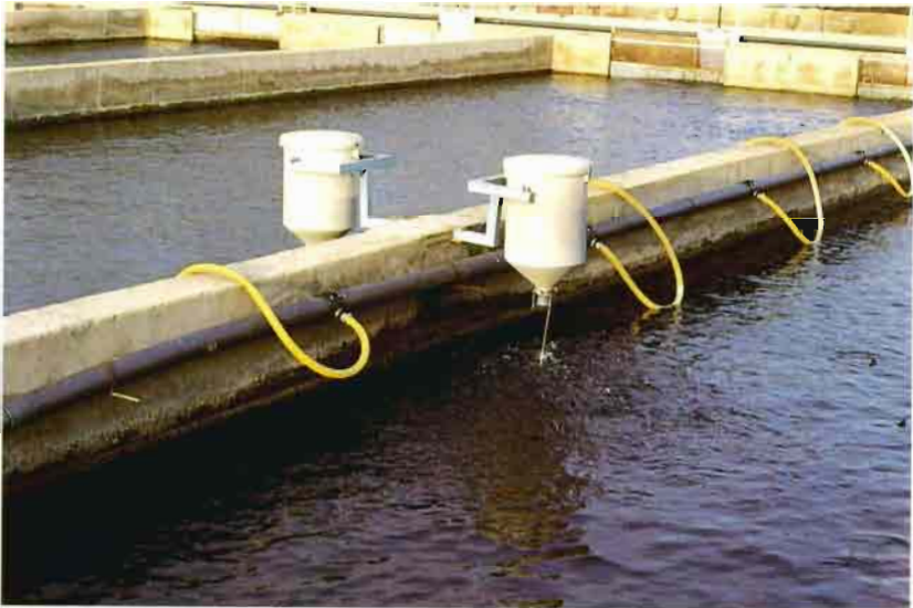
Fig. 3.—Alimentadores empleados en las piscifactorías para proporcionar piensos a la demanda de los peces.
