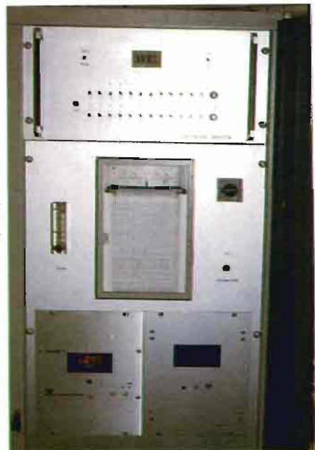
Fig. 8.—Equipo para la lectura de la medida automática de los contenidos en O_2 y CO_2 de las cámaras de atmósfera controlada.
