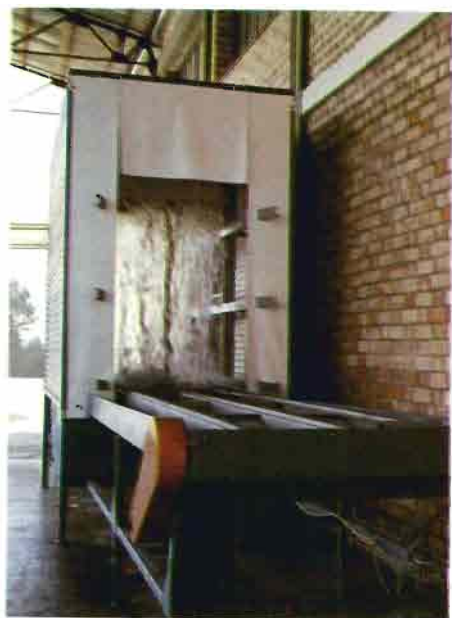
Fig. 5.—Equipo para el tratamiento mediante ducha o cortina de agua de la fruta en poscosecha (drencher).
