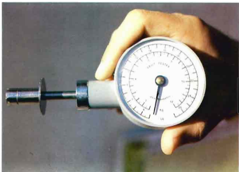
Fig. 1.—Penetrómetro para medir la dureza de la pulpa.
