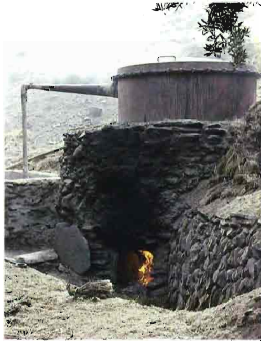
Fig. 7.—Antigua caldera de destilación al vapor de agua, muy usada en la actualidad en la extracción del aceite esencial.
