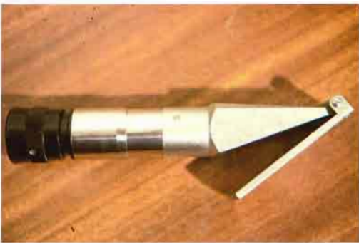
Fig. 11.—El refractómetro mide el contenido en sólidos solubles del zumo de la fruta.
