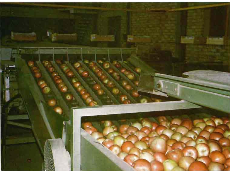
Fig. 3.—Se puede calibrar por diámetro, o por peso.
