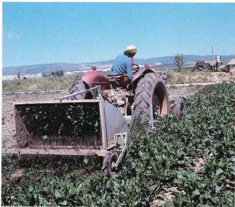
Fig. 6.—Deshojadora de remolacha trabajando en el campo.
