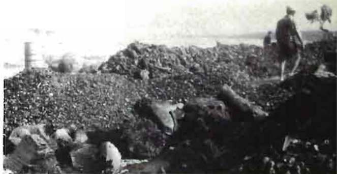
Fig. 4.—Carbón dispuesto para su transporte. En primer término, troncos gruesos sin quemar que servirán para construir una segunda carbonera.
