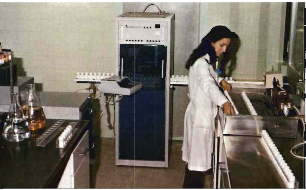
Fig. 15.—Realización en serie del recuento celular para detección de mastitis, por medio de un aparato Fossomatic, en los laboratorios del Centro de Investigación y Desarrollo de la Lactaria Española en Renedo (Santander).
