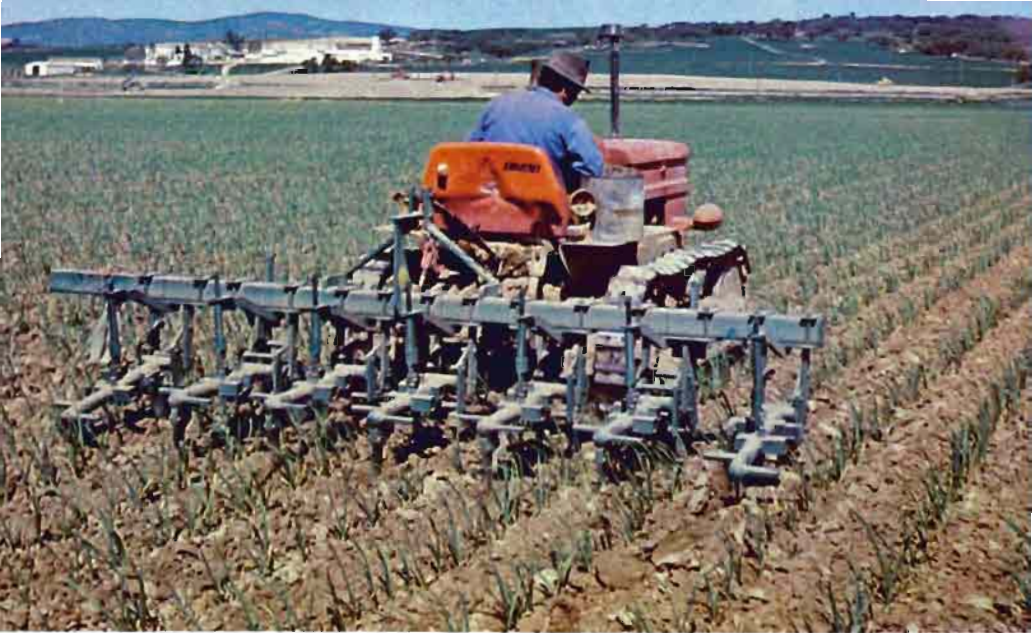
Fig. 7.—Pase de cultivador entre calles de un cultivo extensivo.
