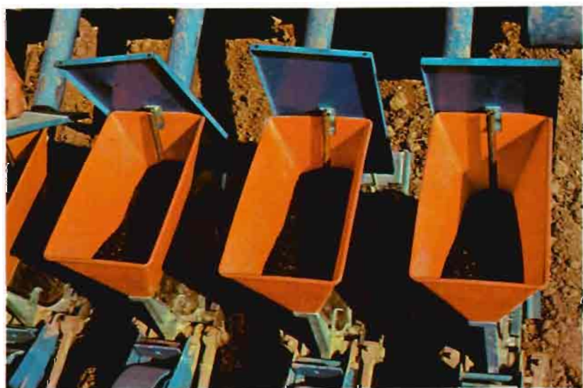
Fig. 6.—Aspecto de las tolvas de una sembradora con semilla de cebolla dispuesta para su siembra.
