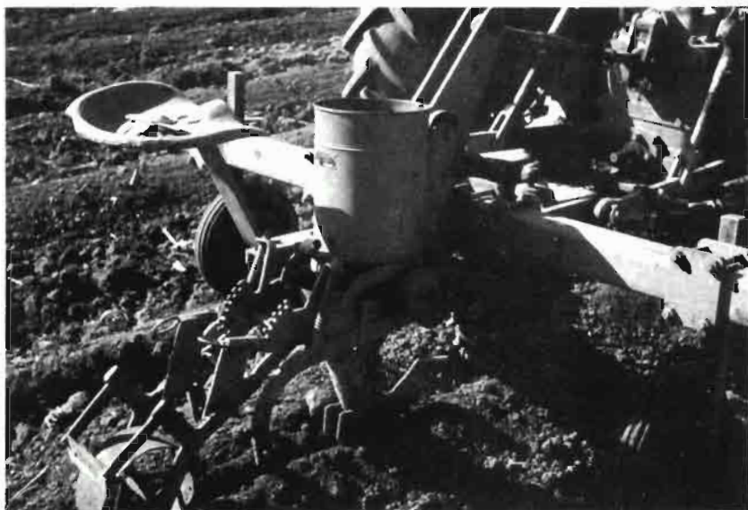
Fig. 3.—Sembradora que puede utilizarse en el cultivo extensivo de cidra, cambiando el disco de siembra.
