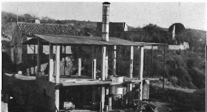
Fig. 3.—Destilería moderna con una sola caldera y serpentín en primer plano, en Jérica (Castellón). Foto S.E.A. de Viver.
