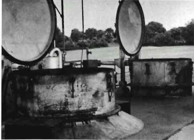
Fig. 5.—Detalle de las calderas y su cierre en una destilería moderna.
