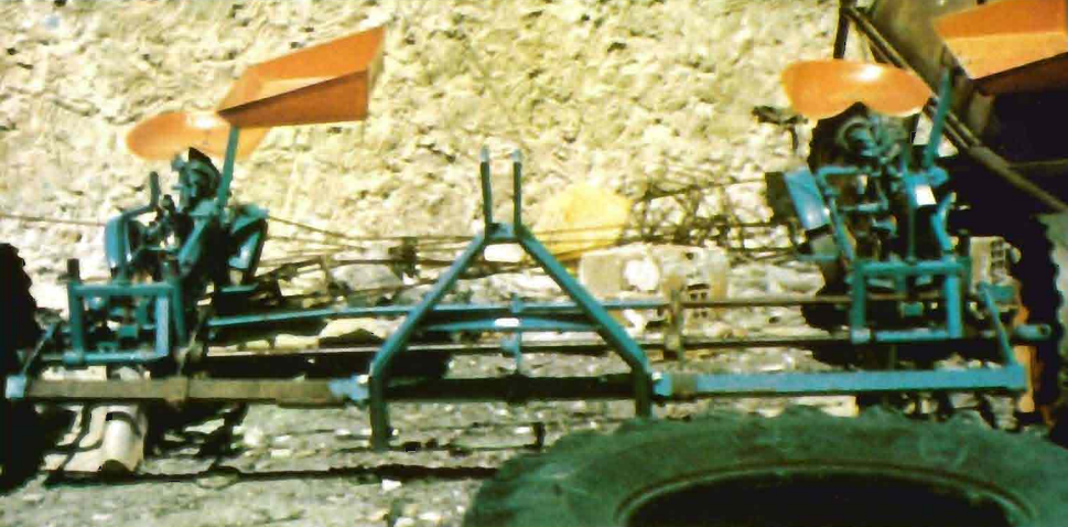
Fig. 2.—Sembradora de patatas, adaptada para la plantación de esquejes. Separación entre líneas adaptable.
