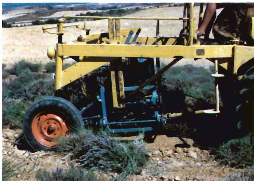
Fig. 9.—Siega mecanizada de lavandín con máquina segadora automotriz.
