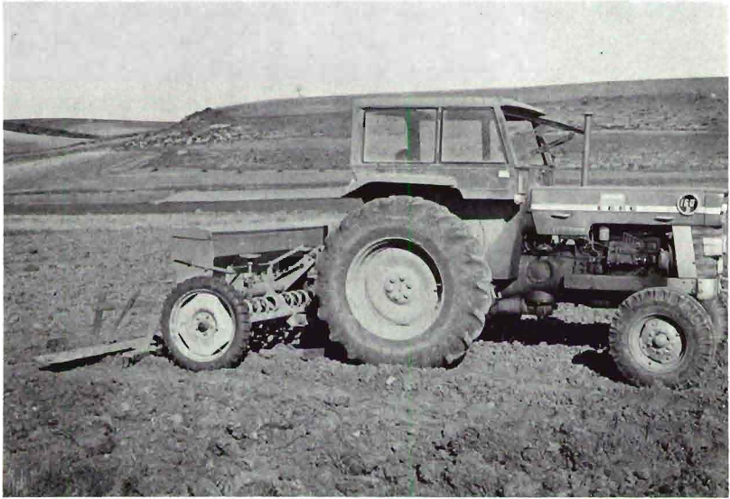
Fig. 2.—La siembra de lentejas con sembradora de cereales da buenos resultados, cuando se utiliza con una separación entre botas de 15 centímetros.
