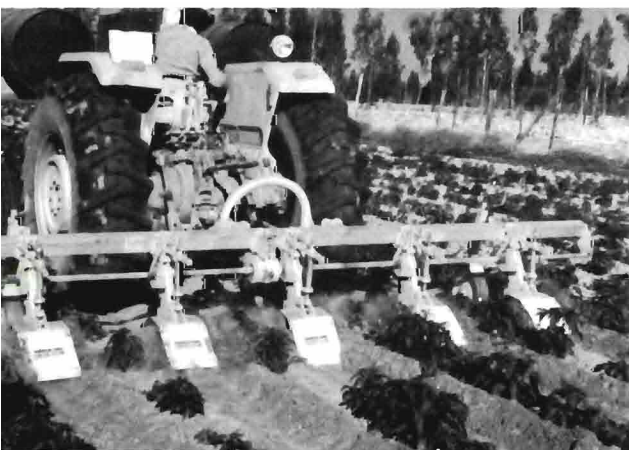
Fig. 4.—Labor entre líneas con rotavator para destruir malas hierbas y mullir el terreno.
