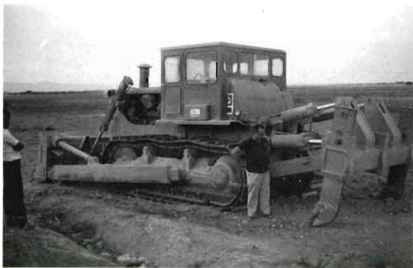
Fig. 4.—Subsolador para labores de 1,7 metros de profundidad.
