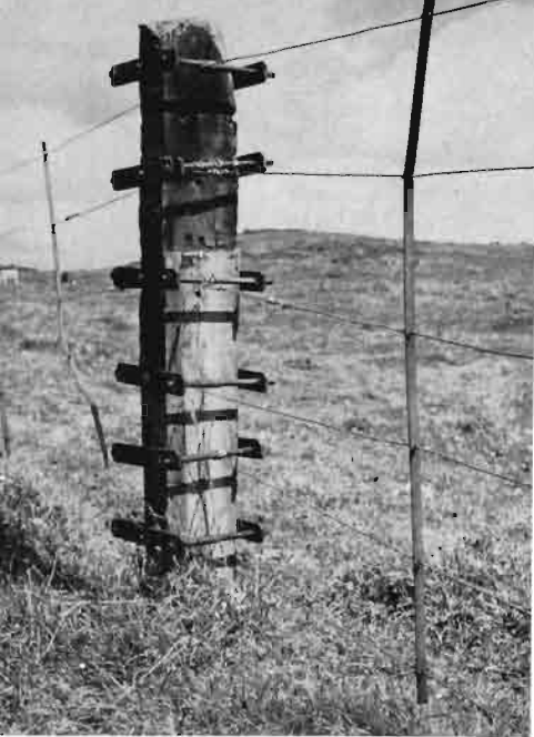
Fig. 11.—Tensores: arriba, de carraca doble; abajo, de husillo a rosca.
