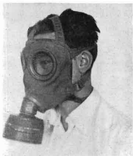
Fig. 5.—Mascarilla protectora contra gases tóxicos, con respirador de bote provisto de cartucho neutralizante del veneno. (De Alfaro.)
