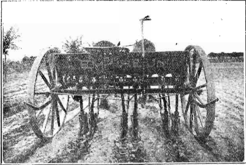
Fig. 1.—Sembradora de nueve discos, modificada, para la siembra en líneas pareadas .
