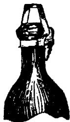
Fig. 13. — Grapillas con cuña de madera para sujetar los tapones, durante la pasteurización en botellas.
