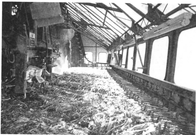
Fotografía 5. Espacio interior de la «plataforma del apio» donde se sitúan los recolectores, que van depositando el apio cortado en la línea móvil de receptáculos. (Fotografía del autor).
