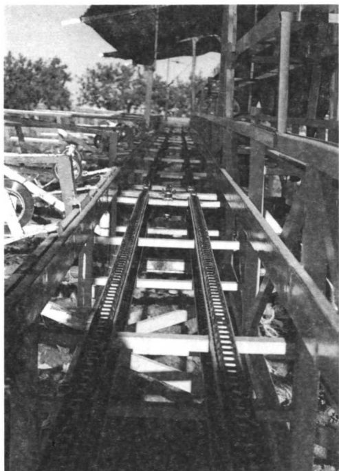
Fotografía 3. Detalle de la cadena sobre la cual circulan las cajas en una línea de recolección de lechuga (Campo de Cartagena). (Fotografía del autor).
