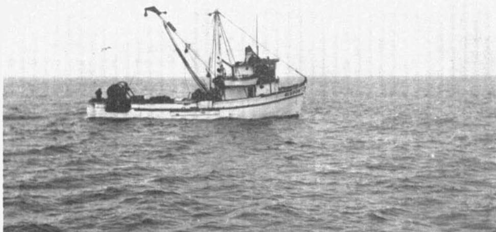
Fot. 50.—Arrastrero de popa semiabierto con tambor hidráulico para la estiba de la red.
