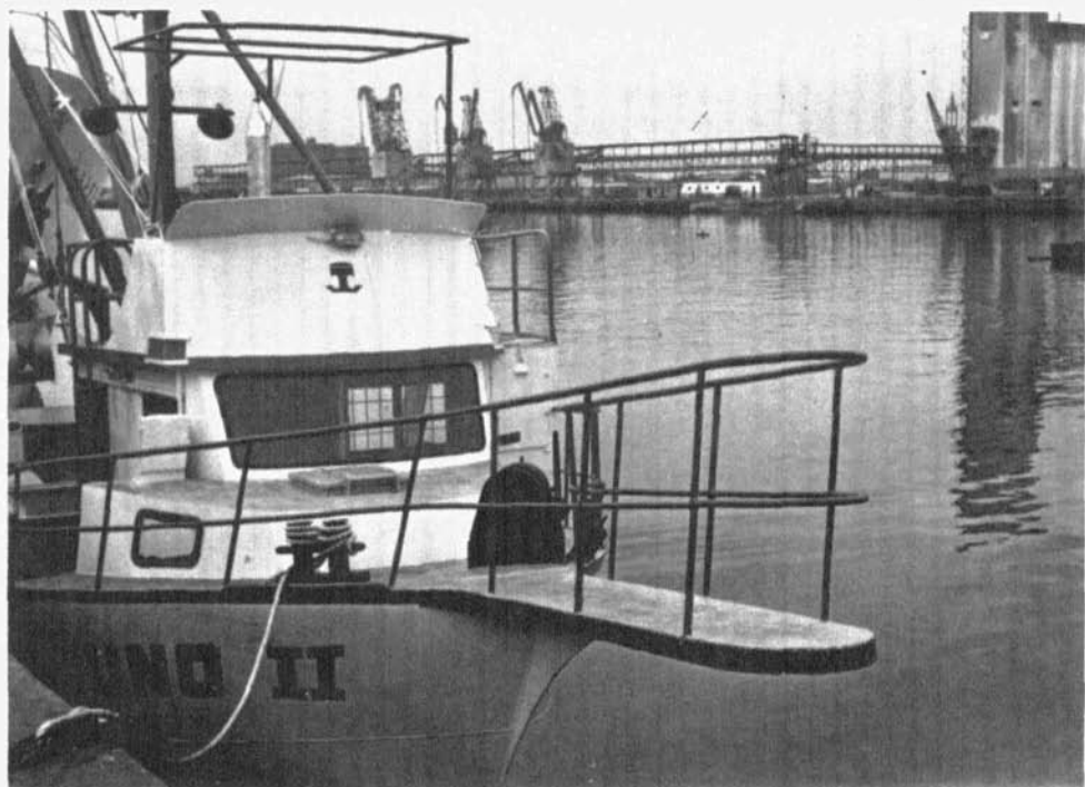
Fot. 1.—Embarcación con plataforma a proa para la pesca con arpón de mano.
