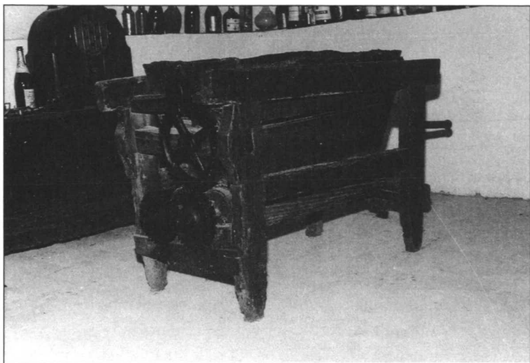
Trepitjadora manual con rodillo ( Curro ) de madera estriada. La Granada (Alt Penedés) Fot. aut.
