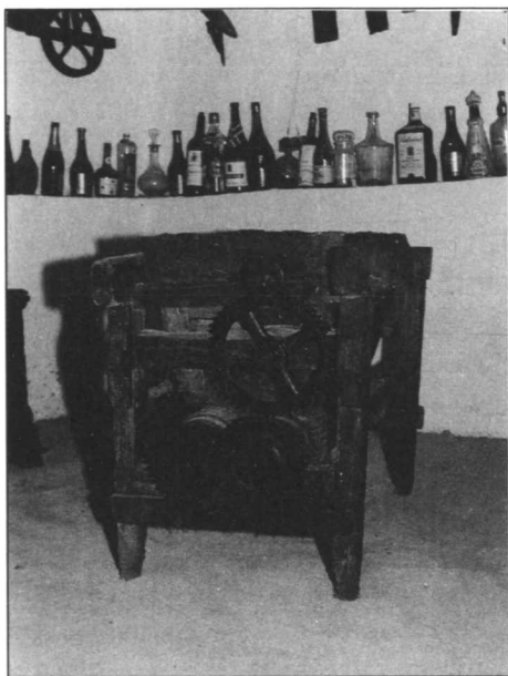
Trepitjadora manual con rodillo ( Curró ) de madera estriada. La Granada (Alt Penedés) Fot. aut.
