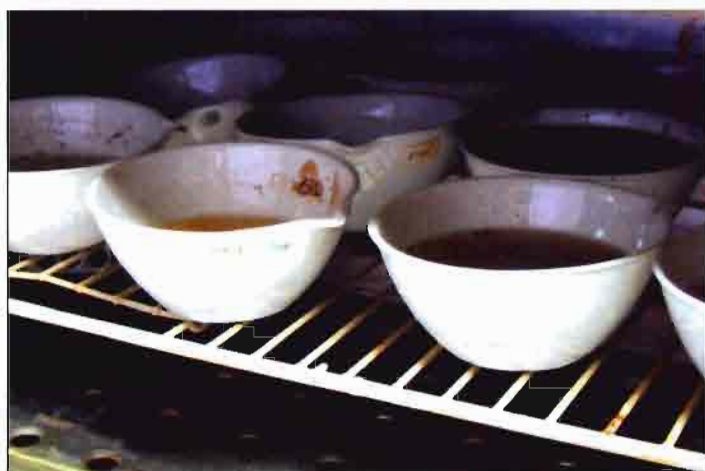
Una vez anotado el peso de sedimentos acumulados en el recipiente, se extrapolan los resultados obteniéndose la cantidad de material erosionado acumulado en el bidón.
