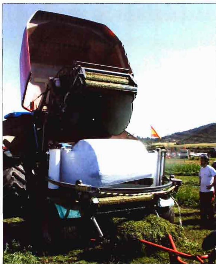
Foto 7. Encintadora con encintado en la cámara de empacado. Documentación I Kverneland.
