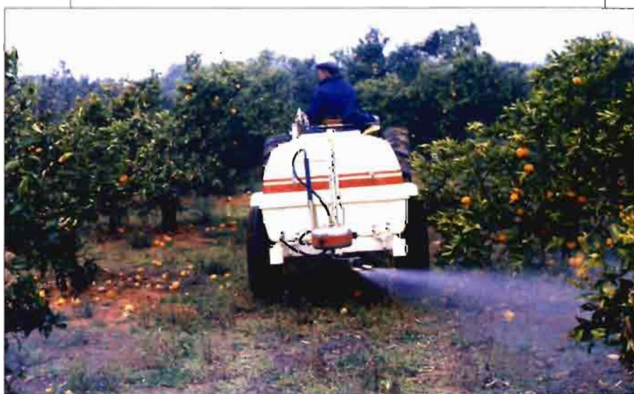
Pulverizador de alto rendimiento para tratamiento herbicida con pistola oscilante sin carenar. Muy útil al cubrir toda la superficie de terreno, pero con el inconveniente de que al trabajar en campos con irregularidades en el terreno el herbicida moja las zonas bajas de los naranjos, razón por la que debe estar prohibida al no realizar una aplicación selectiva.
