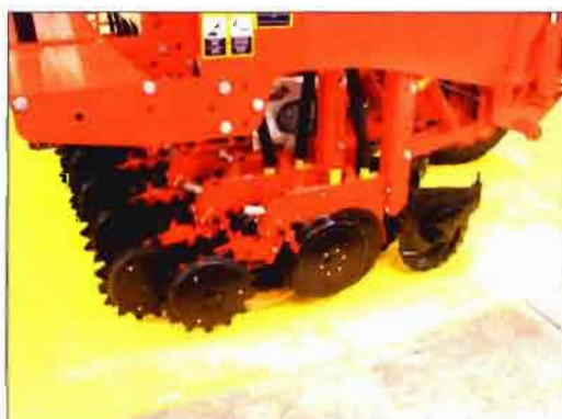
Foto 11. Sembradora directa de discos y patines de apoyo en disco de corte del rastrojo.
