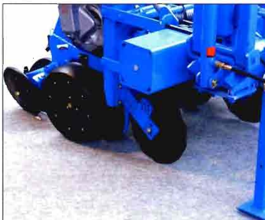
Foto 5. Disco de corte de residuos de una sembradora de precisión.
