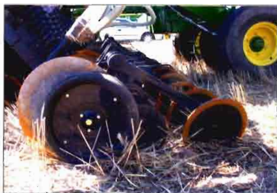
Foto 8. Ejemplo de cubrición o cierre del surco con rueda inclinada. La rueda pequeña intermedia es para la fijación de las semillas en el fondo del surco.
