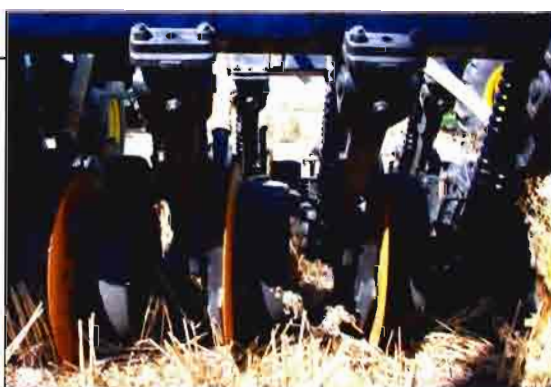
Foto 9. Ejemplo de control de la profundidad con ruedas neumáticas adosadas al disco de apertura del surco de siembra.
