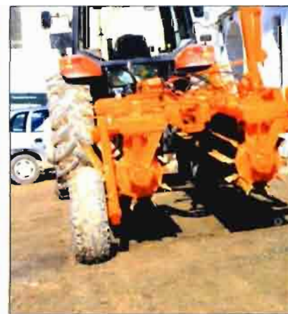
Foto 3. Equipo de picado de cañas de girasol en p...
