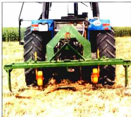
Foto 4. Cultivador de ala ancha para laboreo subsuperficial.
