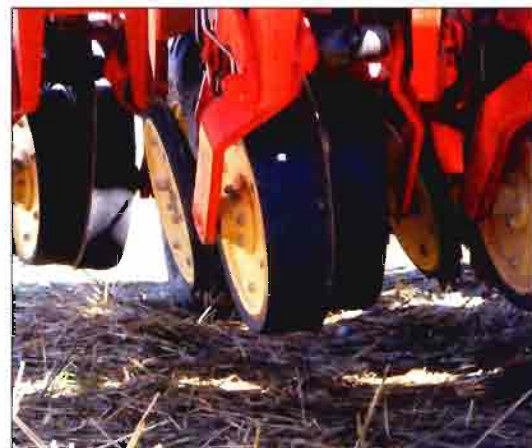
Foto 6. Sistema de apertura de doble disco.
