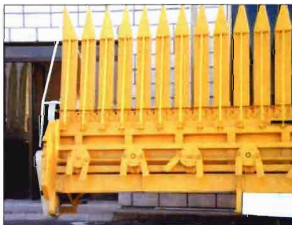
Foto 2. Cabezal picador de girasol con mecanismo de picado de cañas.
