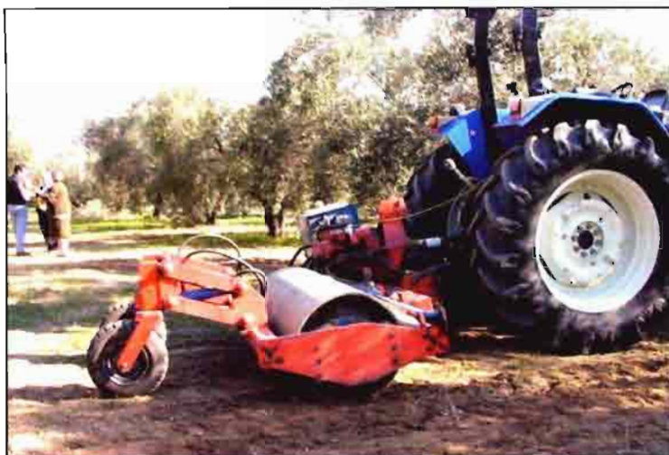
Figura 3. Rulo compactador dotado de movimiento vibratorio.
