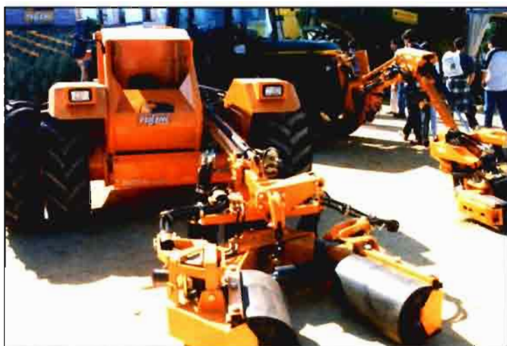
Figura 11. Pinza orbital en un vibrador autopropulsado.
