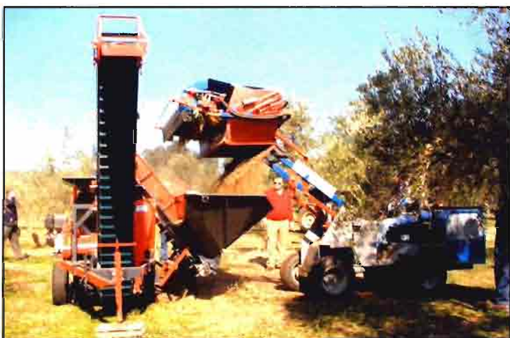
Figura 18. Descarga de una barredora-recogedora sobre la tolva de una limpiadora.
