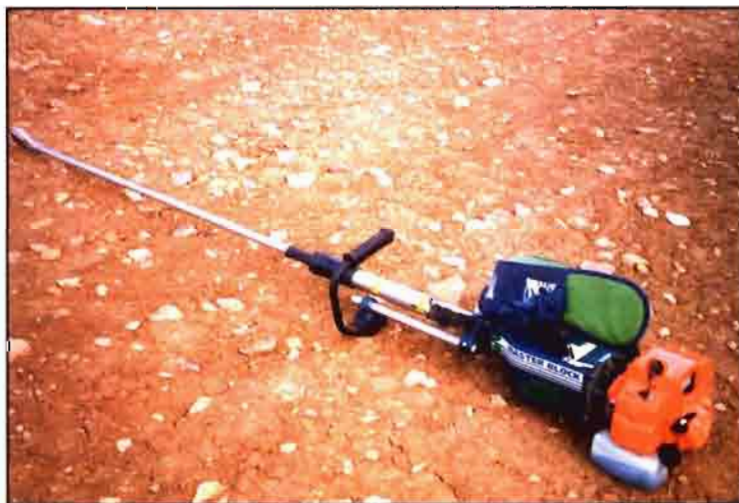
Figura 6. Vibrador de ramas de tipo mochila
