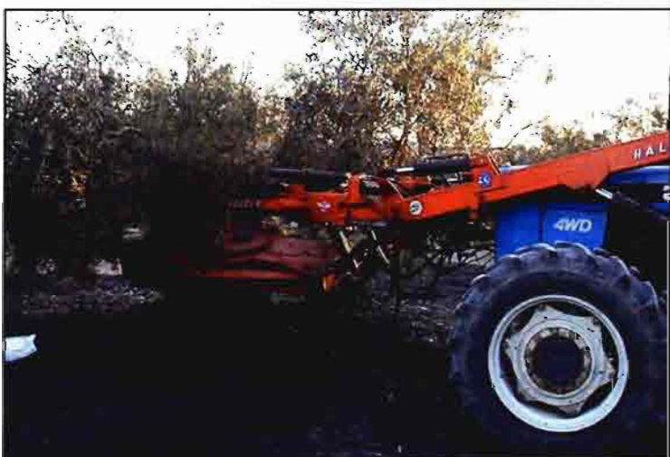
Figura 9. Pinza multidireccional con motor de accionamiento y sistema de agarre.
