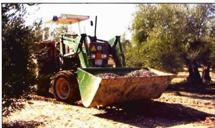
Figura 14. Pala de gran capacidad para manejo de aceituna
