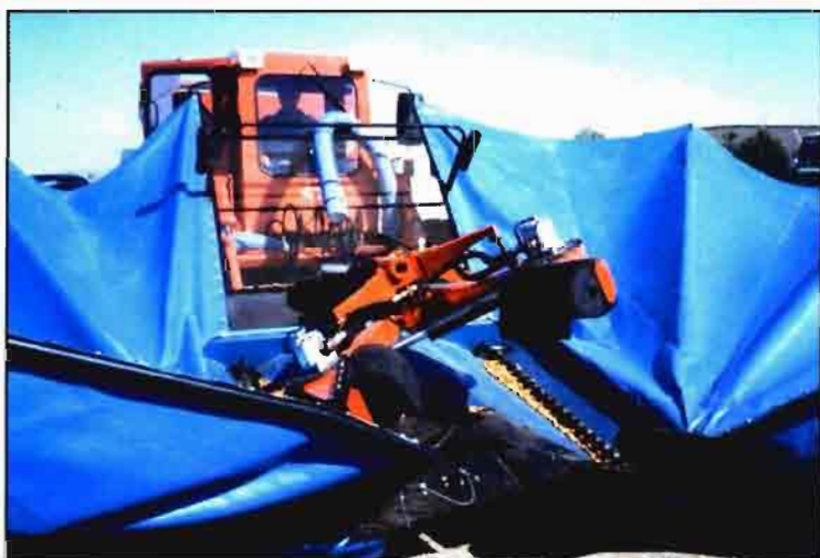
Figura 10. Pinza multidireccional con dos motores hidráulicos.
